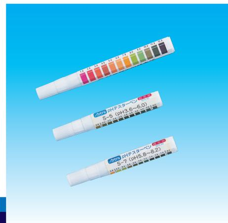
用紙の pH は、その保存性やインキ乾燥不良などの印刷トラブルを未然に防ぐために測定しておく必要があります。しかしながら、用紙を水に浸して抽出液を pH メーターで測定するには時間と手間がかかります。『アストロ pH テスターペン』は用紙や布などの固体表面の pH を簡易に測定できるペンです。
