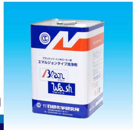
一般的なブランケット洗浄剤では、ブランケット表面にインキ以外の紙粉などが残り、水拭きなどで対処されております。『ブランウォッシュ』は、油と水とを乳化させたエマルジョン型洗浄剤ですので、インキ以外の汚れも洗浄できます。インキローラー洗浄の仕上げ剤として日常のメンテナンスにご使用ください。
