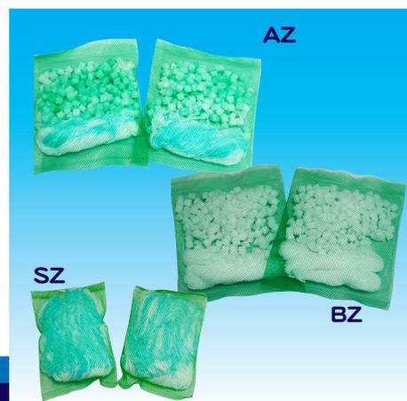
優れた吸油力を発揮するオフセット湿し水循環機用油分吸着材です。三次元立体構造の特殊繊維で作られており、製品 1 個当たりの総表面積はテニスコート 1 面以上に相当します。油分のみを吸着して水分を吸収しないので、湿し水循環装置内に浮遊するインキ油分を有効に吸着させることができます。AZ 及び SZ タイプには防腐剤を含浸させてありますので、水腐れ対策としても兼用させることができます。また、防腐剤は有害性の低い成分で効果を発揮するように開発しました。
