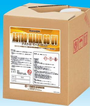
溶剤を含まないことで環境に優しいとされている UV インキは短納期や非吸収紙への印刷などの多様化する要望が高まり、ますます需要が増えてあります。しかしながら、湿し水中に混入するカルシウムが給湿液成分であるクエン酸と結合することによりクエン酸カルシウムが結晶化し、ローラー表面に沈着することでグレーズを助長するトラブルが見受けられます。『アストロマーク 66UV』は、カルシウム封鎖効果と合わせて、クエン酸を含有しないことでクエン酸カルシウムの結晶化を回避できる UV インキ対応の枚葉機用給湿液として開発いたしました。
